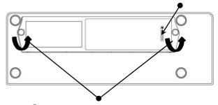
Öffnen Sie die 2 Rändelschrauben, um den Akku zu entnehmen und auszutauschen.
