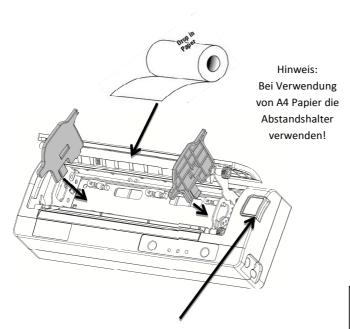
Drücken Sie die Entriegelung, um das Papierfach zu öffnen. Legen Sie das Papier ein und schließen das Papierfach, welches mit einem "Klick" richtig einrastet.
