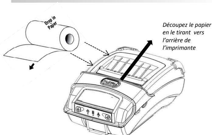
Appuyez sur le bouton déverrouillage pour ouvrir le compartiment papier. Tirez un peu sur le papier et refermez le compartiment papier. Le "Clic" indique qu'il est correctement fermé.
